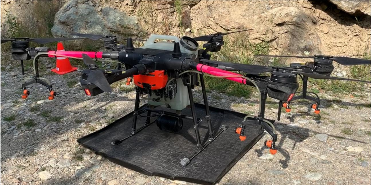
C'est particulièrement avec les petits appareils (comme ici un drone, mais aussi les atomiseurs) que la préparation et le remplissage se font sur le terrain. On peut alors utiliser un bac de rétention avec bordures comme place de remplissage mobile.
