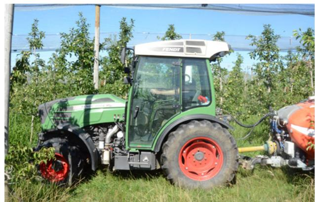
Nur mit einer Traktorkabine Kat. 4 oder äquivalent (dreistufige Filtrierung) kann beim Ausbringen auf PSA verzichtet werden.
