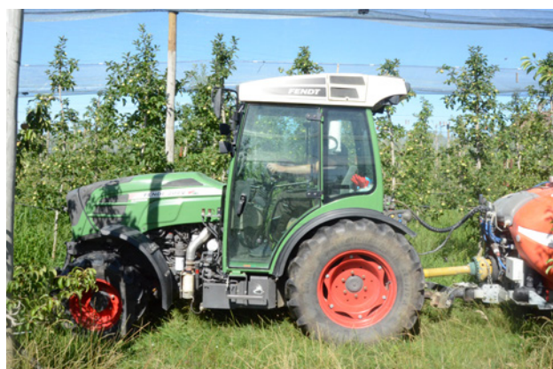
Il est possible de se passer d'EPI pour l'épandage seulement si le tracteur est équipé d'une cabine cat. 4 ou équivalent (filtre trois étages).
