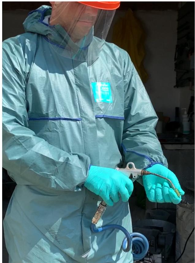
*Sûr et efficace : nettoyage des buses à l'air comprimé avec des vêtements de protection.*
