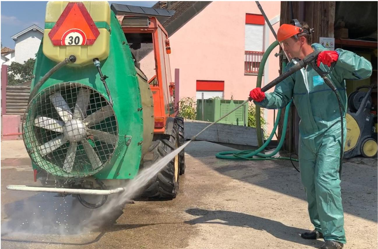
Pour le nettoyage, porter un écran protège-visage, un tablier à manche ou une combinaison de protection, des gants pour les PPh et des chaussures.
