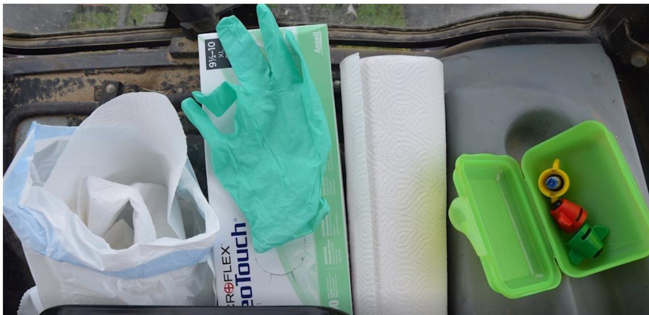
*Sempre a portata di mano sul trattore : ugelli di ricambio e DPI adeguati per sostituirli direttamente in campo.*
