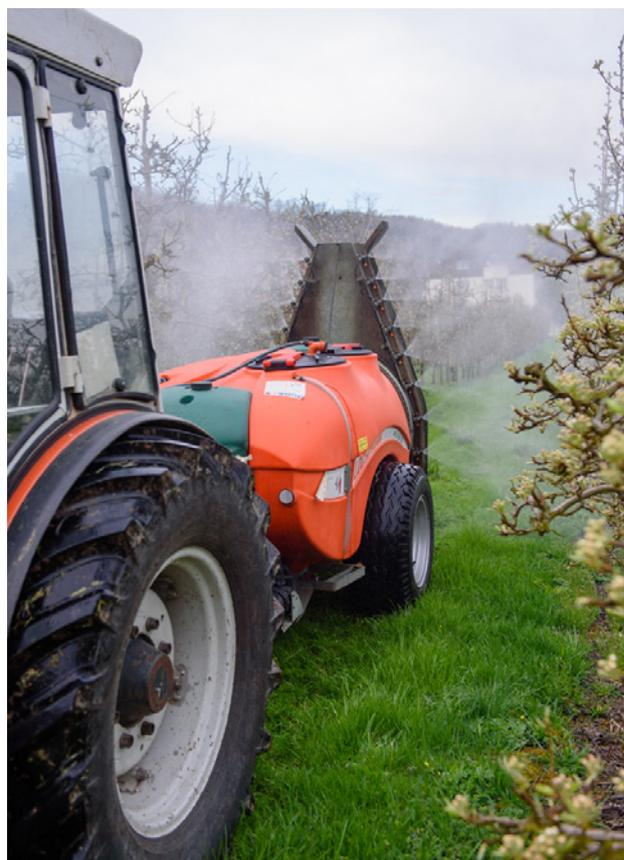
Avec les turbodiffuseurs et les atomiseurs, les tourbillons peuvent être considérables. C'est pourquoi les travaux consécutifs à proximité de ces engins en action doivent être évités.
